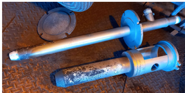
Figura 9. Queimador Low Nox e Camisa de ar.
